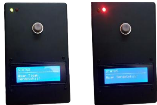
Gambar 12. (a) LED hijau indikator asap tidak terdeteksi; (b) LED merah indikator asap terdeteksi
