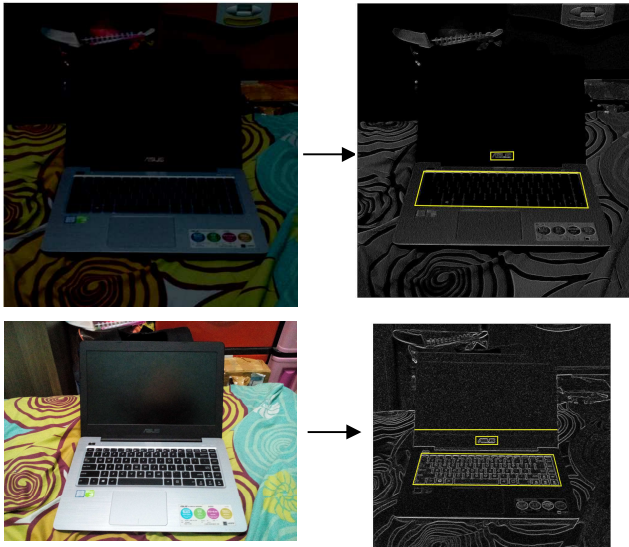
Gambar 6. Tes keakuratan penentuan objek dengan pencahayaan
