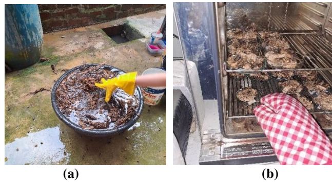
Gambar 2. Pencucian TKKS (a) dan Pengeringan TKKS (b)
