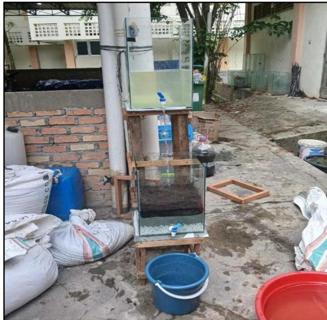
**Gambar 3.** Kondisi Aktual Reaktor Unit Filtrasi
