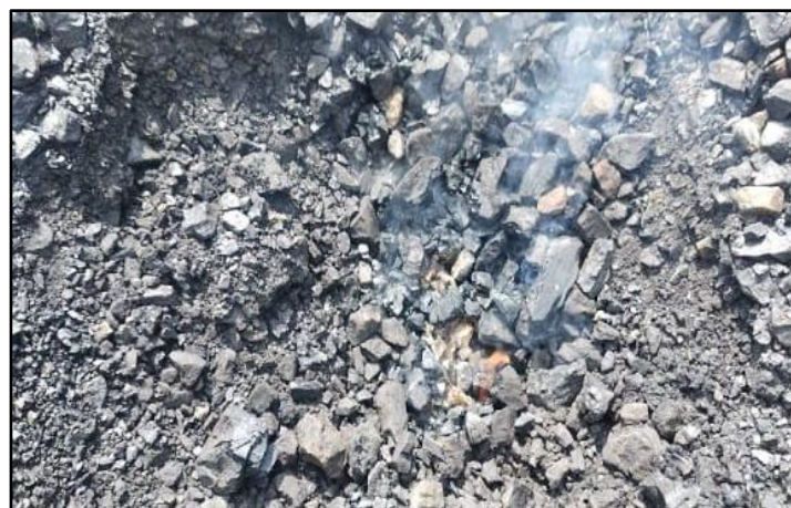
Gambar 9. Partikel batubara yang mengalami self-heating
