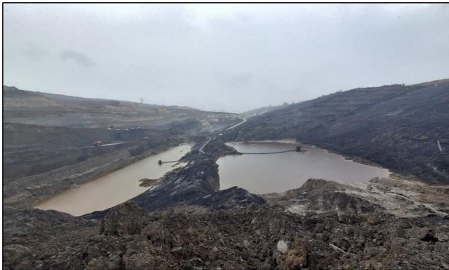
Gambar 3. Keadaan Sump aktual di Pit Tempudo 4
