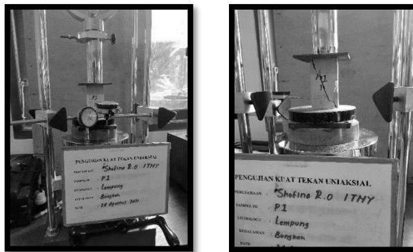
Gambar 5. Sebelum Pengujian Kuat Tekan dan sesudah pengujian
